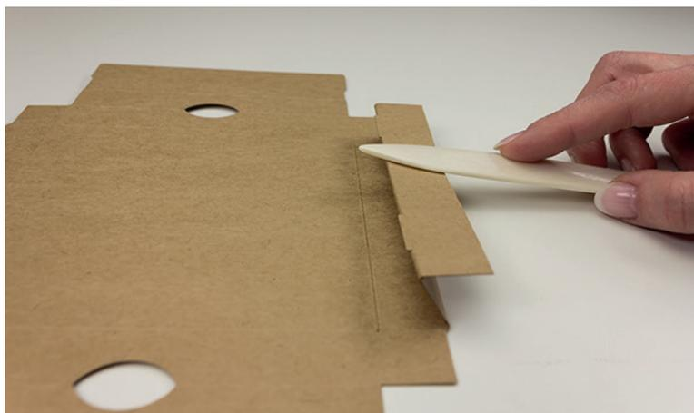
4. Falten Sie an der dritten, äußeren Rille das Seitenelement in die entgegengesetzte Richtung.
