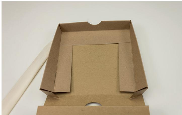
10. Die Seitenwände sind aufgerichtet. Die Frontseite ist ebenfalls aufgerichtet und über die Einstecklaschen geklappt. Vorne sehen Sie die noch offene Rückseite, die noch aufgerichtet und über die beiden Einstecklaschen der Seitenwände geklappt werden müssen.
